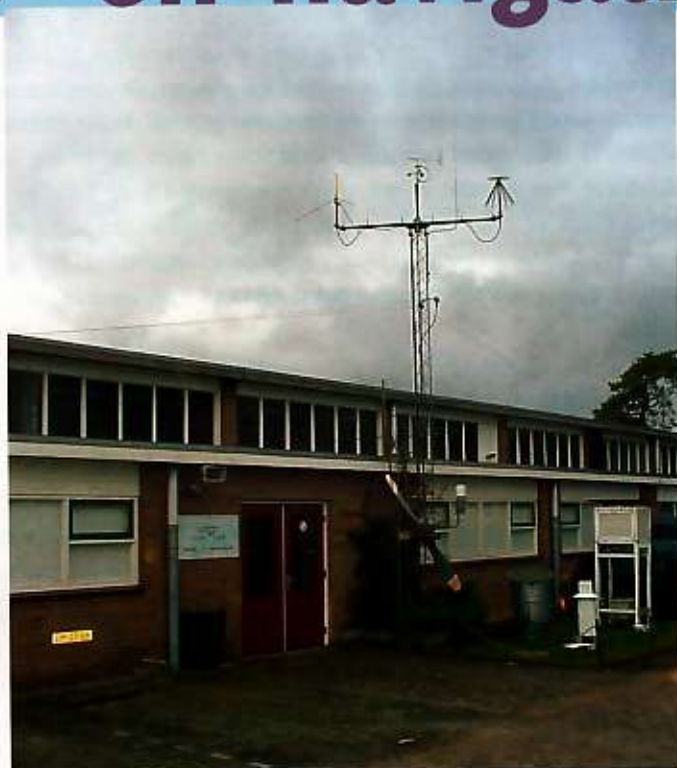
Gebouw 9, waarin de tentoonstelling is ondergebracht. Buiten staat de mast met de antennes voor de ontvangst van HF, VHF en UHF signalen. In het witte kastje zitten de instrumenten voor de Meteoapparatuur.
